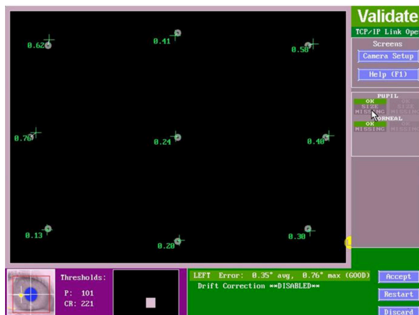
Figure 26. Exemple de résultat d'une validation. Les points représentent les lieux à fixer sur l'écran, les croix représentent la position de la pupille quand ces lieux étaient fixés, les chiffres représentent l'écart (en degrés d'angle) entre les coordonnées des lieux sur l'écran et les coordonnées de la pupille détectés lorsqu'elle fixait ces lieux
